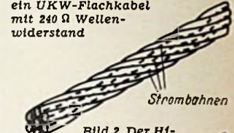
Bild 2. Der Hf-Strom folgt den verdrillten Litzenadern kaum
