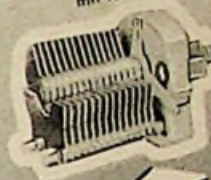
Kombinierter UKW Drehkondensator mit isoliertem Rotor
