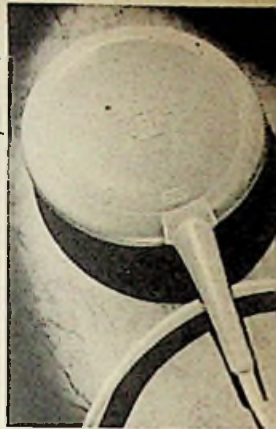
Bild 3. Ansicht des Kopfkissen-Leisesprechers der Firma Ronette
